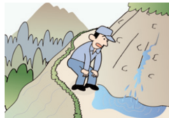
③斜面から水が噴き出す
