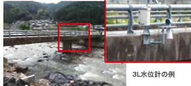
クラウドサービスを用いた水位情報提供システム
