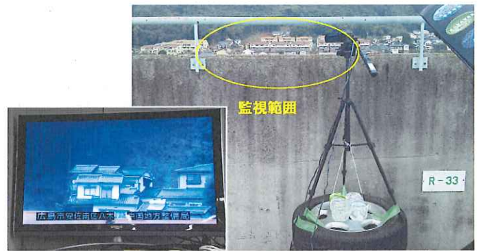
監視カメラ設置と配信状況
